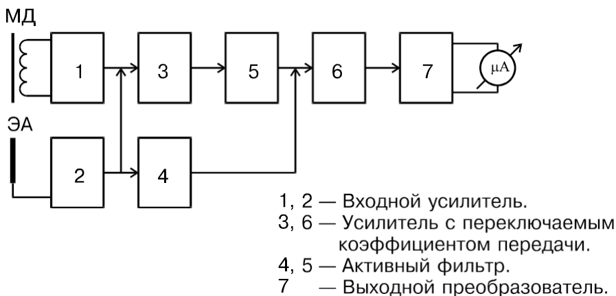
Рис. 1. Структурная схема прибора «Квант-К»
