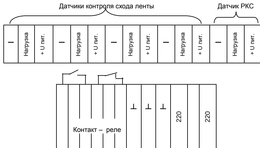
Рис. 2 Схема подключения устройства.
