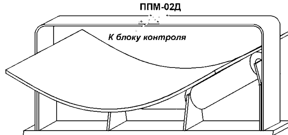
Рис. 9. Контроль наличия продукта на движущейся ленте конвейера.
