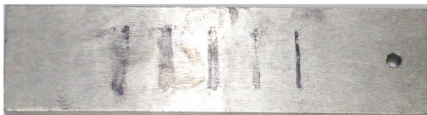
Рис. 5. Дефектограмма искусственных дефектов на образце МО-3
