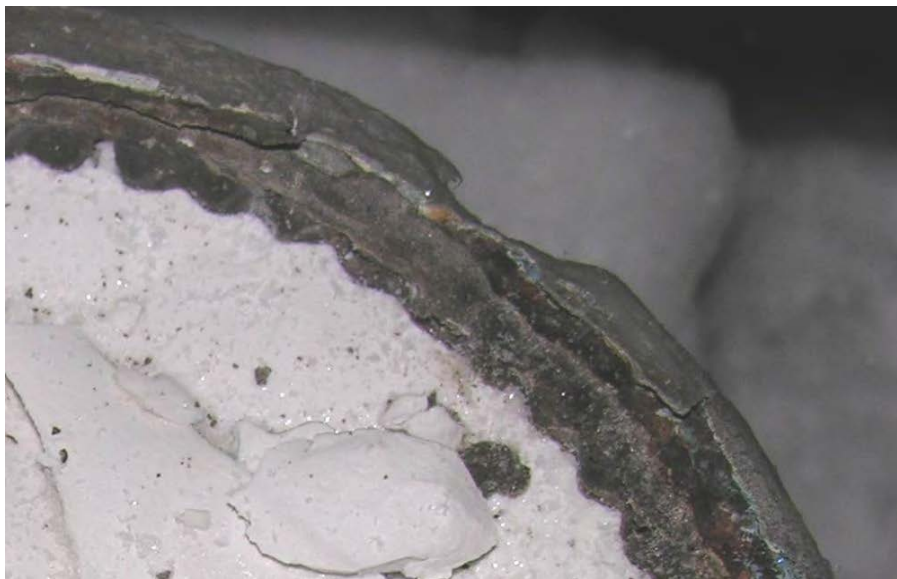
Рисунок А.21 – Увеличенный вид трещины в армировочном шве изолятора ИОС 110-600
