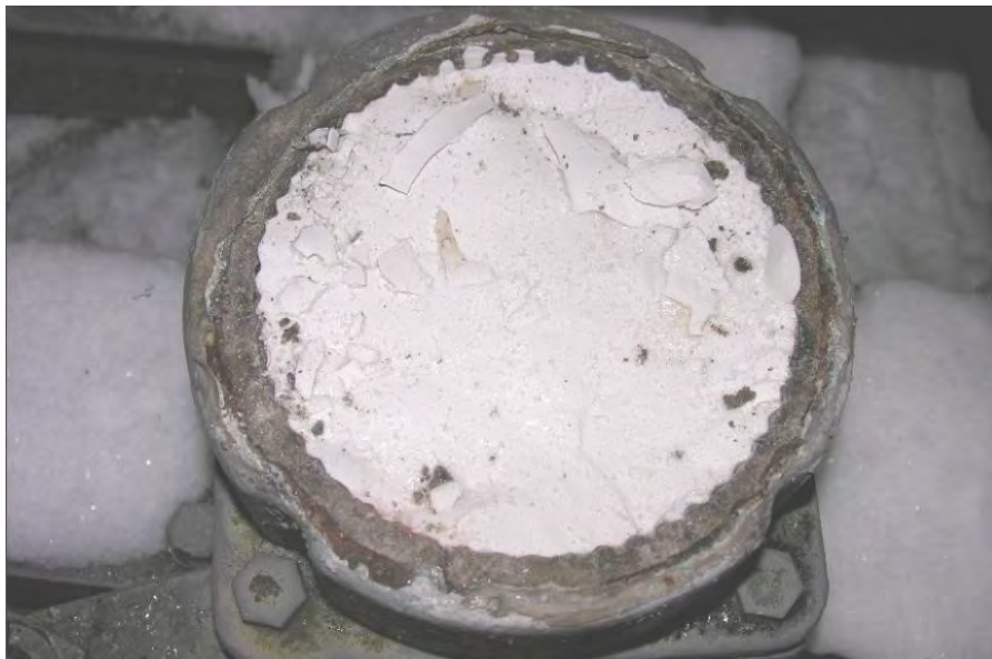
Рисунок А.20 – Нижний фланец изолятора ИОС 110-600. Разрушился на разъединителе
