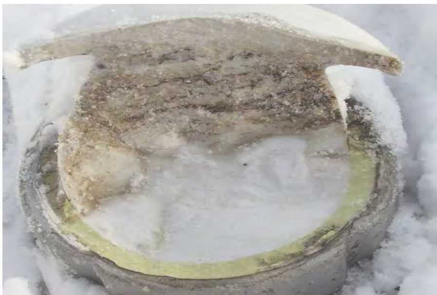
Рисунок А.22 – Нижний фланец изолятора ИОС 110-600. Разрушился при демонтаже
