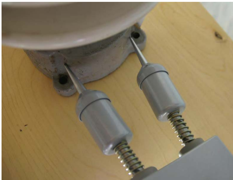
Рисунок 13 — Поперечный изгиб щупов БР
