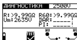
Рисунок 5.7: Пример результатов диагностической проверки в случае, когда результаты сопротивления выходят за предел измерения
