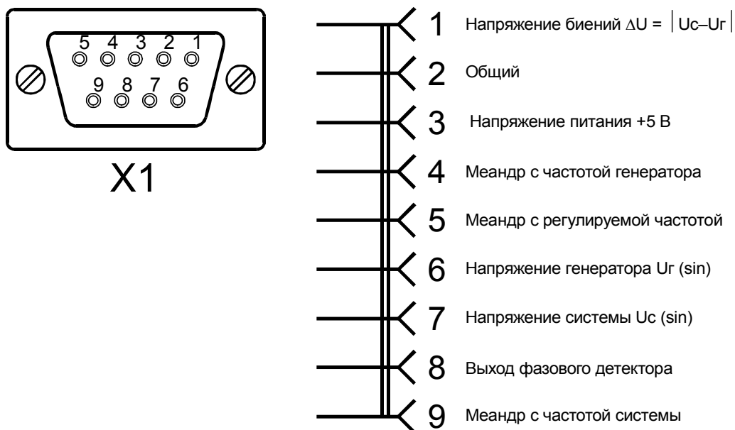
Рис. 10. Функциональное назначение контактов контрольного разъема X1 модуля ПРЦ
