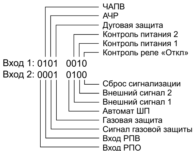
Рис.8. Соответствие входных дискретных сигналов в режиме «Контроль входов 1, 2». Активному состоянию соответствует «1», пассивному – «0».
