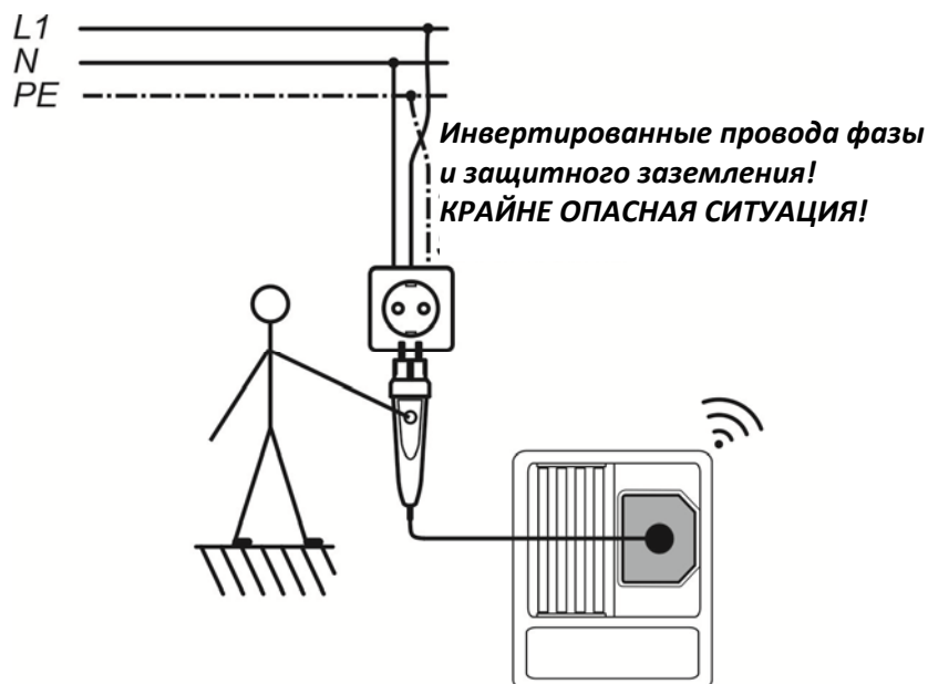
Рисунок С.4: Инвертированные проводники L и PE (применение щупа «plug commander»)
