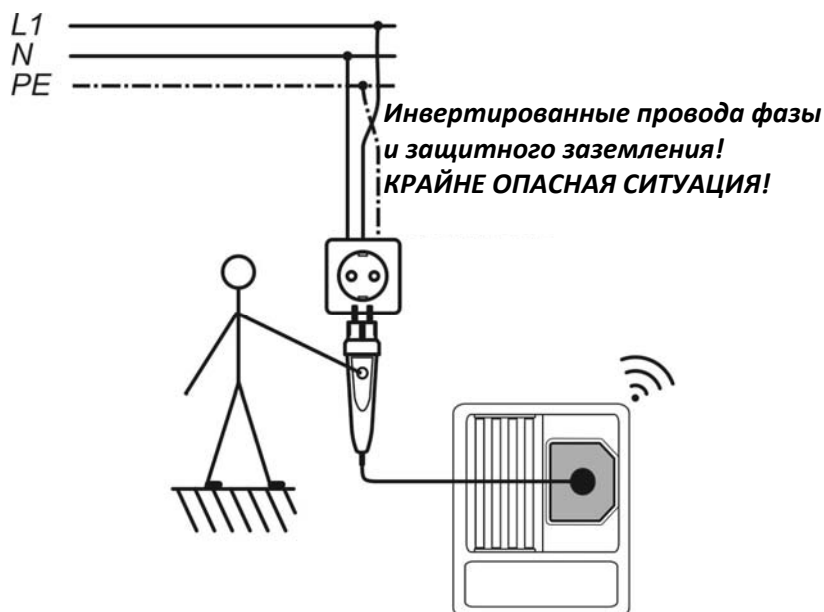
Рисунок 5.69: Инвертированные провода фазы и защитного заземления (L и PE) (щуп типа командер с вилкой (plug commander))
