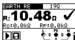
Рисунок 5.27: Пример результатов измерения сопротивления заземления
