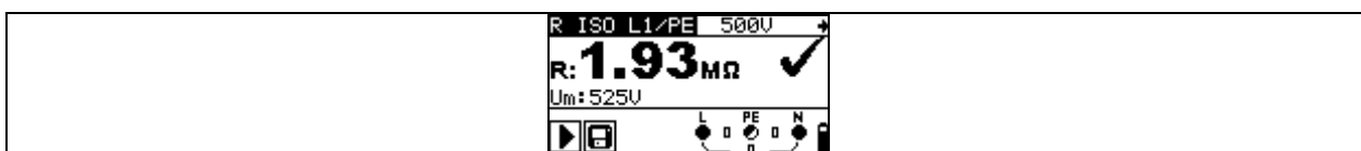
Рисунок 5.4: Пример результатов измерения сопротивления изоляции
