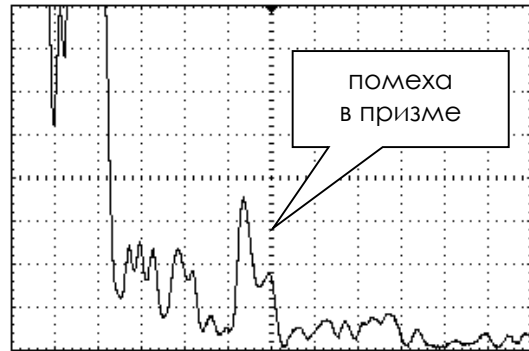
Вид экрана дефектоскопа на поисковой чувствительности (+12 дБ)
