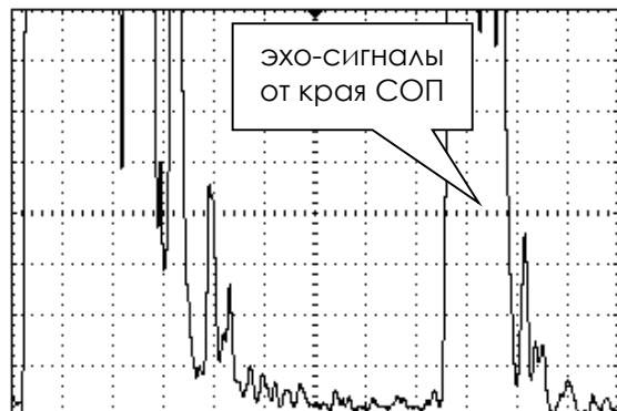
Вид экрана дефектоскопа на поисковой чувствительности (+12 дБ)
