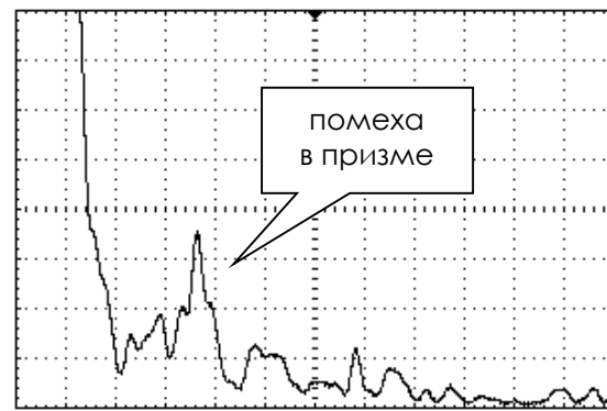
Вид экрана дефектоскопа на поисковой чувствительности (+12 дБ)
