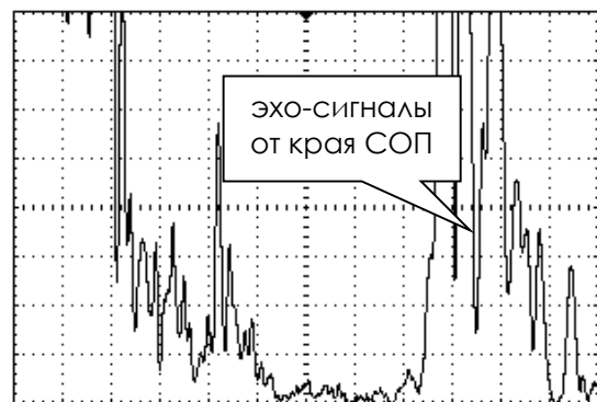
Вид экрана дефектоскопа на поисковой чувствительности (+12 дБ)
