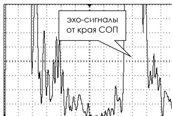
Вид экрана дефектоскопа на поисковой чувствительности (+12 дБ)
