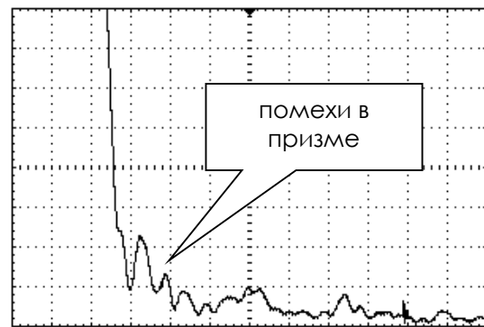
Вид экрана дефектоскопа на поисковой чувствительности (+12 дБ)
