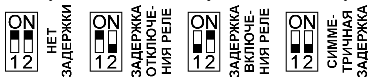
Рис. 6. Внутренние переключатели датчика.
