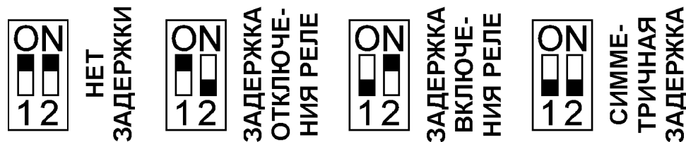
Рис. 3. Внутренние переключатели датчика.
