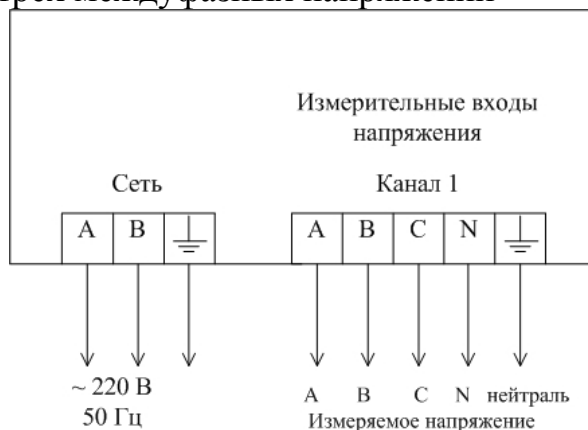
Рисунок Ж.7 Пятипроводная схема подключения прибора для измерения характеристик четырех фазных и трех междуфазных напряжений
