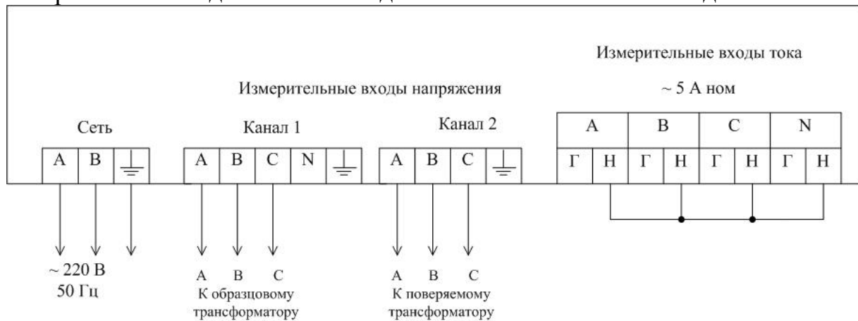
Рисунок Ж.10 Схема подключения прибора при проверке трехфазных трансформаторов напряжения с соединением выходных обмоток по схеме «треугольник»
