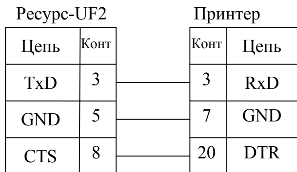
Рисунок Ж.4 Схема подключения прибора к принтеру фирмы EPSON с использованием сигнала готовности приемника
