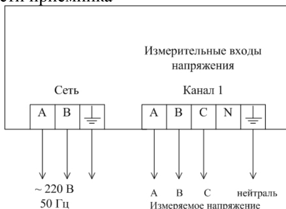
Рисунок Ж.6 Четырехпроводная схема подключения прибора для измерения характеристик трех фазных и трех междуфазных напряжений
