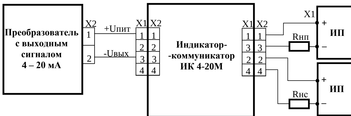
Рисунок А.2 Схема подключения ИК 4-20М к преобразователю с выходным сигналом 4 – 20 мА.
