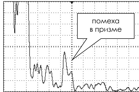
Вид экрана дефектоскопа на поисковой чувствительности (+12 дБ)
