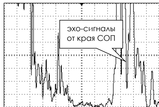
Вид экрана дефектоскопа на поисковой чувствительности (+12 дБ)
