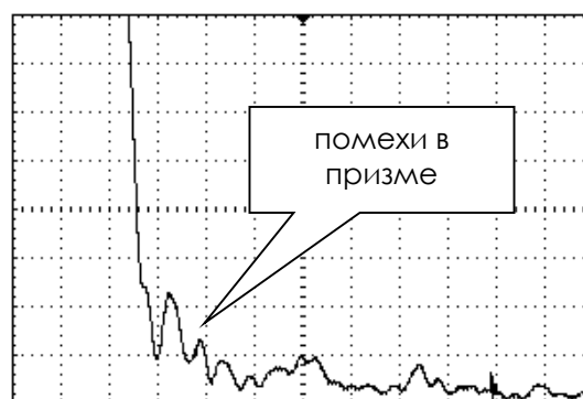
Вид экрана дефектоскопа на поисковой чувствительности (+12 дБ)
