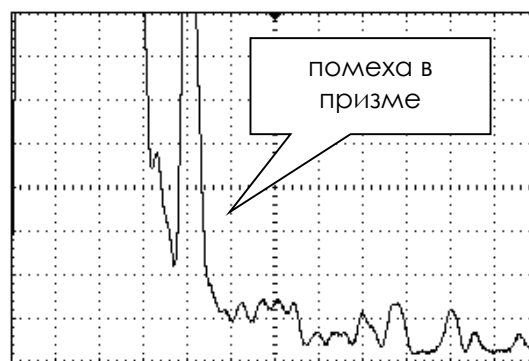
Вид экрана дефектоскопа на поисковой чувствительности (+12 дБ)
