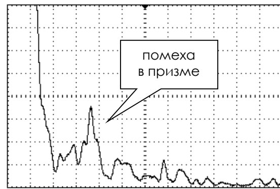
Вид экрана дефектоскопа на поисковой чувствительности (+12 дБ)
