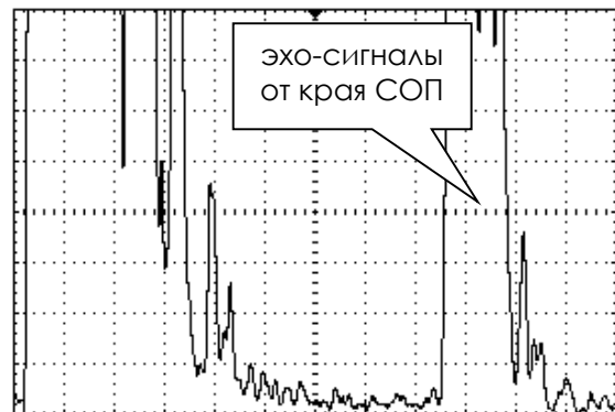
Вид экрана дефектоскопа на поисковой чувствительности (+12 дБ)
