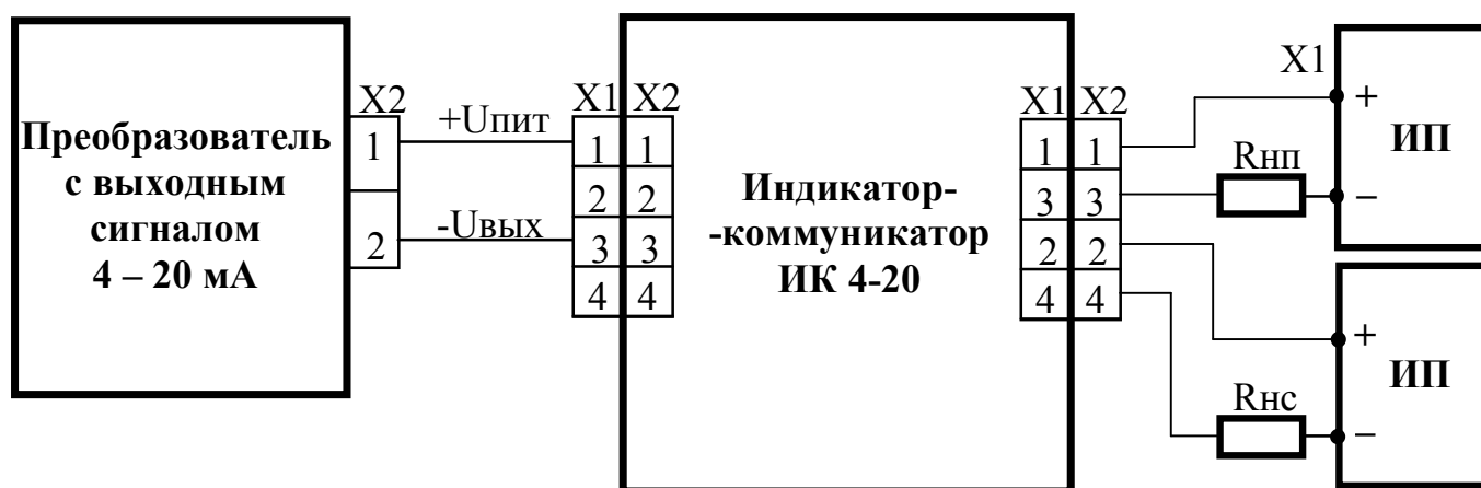
Рисунок А.2 Схема подключения ИК 4-20 к преобразователю с выходным сигналом 4 – 20 мА.
