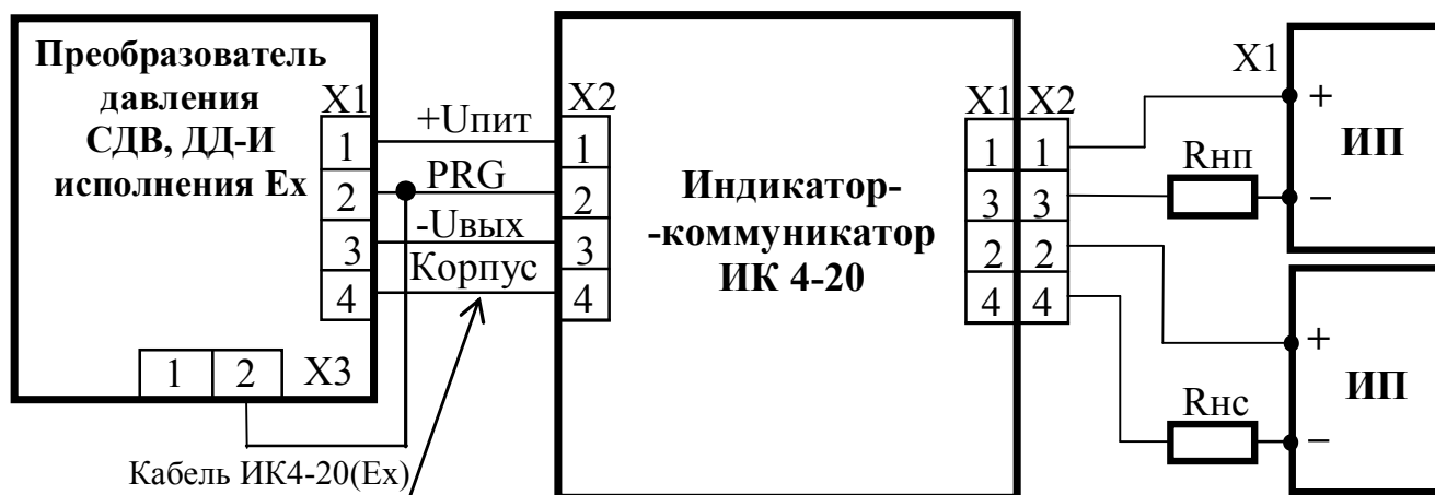
Рисунок А.3 Схема подключения ИК 4-20 к преобразователю с выходным разъемом 2РМД (разъем X3 кабеля не подключать) и преобразователя исполнения Eh (разъем X3 подключить, отвернув крышку) с выходным сигналом 4 – 20 мА
