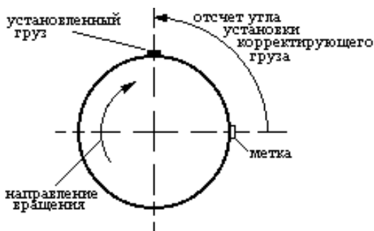
Рисунок 1.4 Схема установки корректирующего груза
