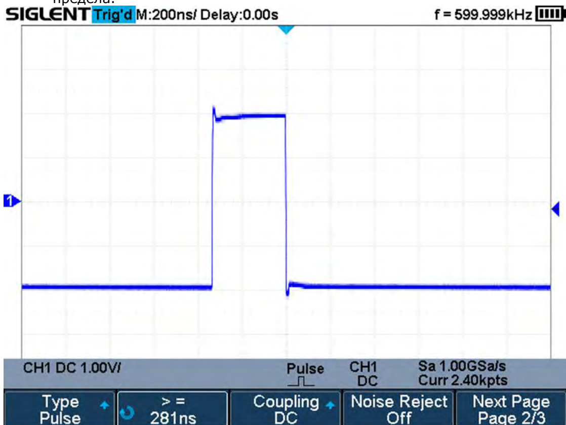
Рис. 11-5 Синхронизация по длительности импульса
