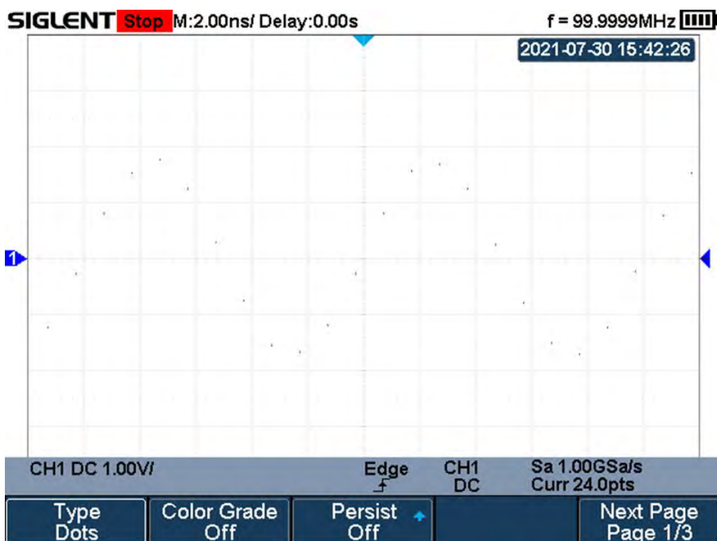
Рис. 17-2 Точечное отображение сигнала
