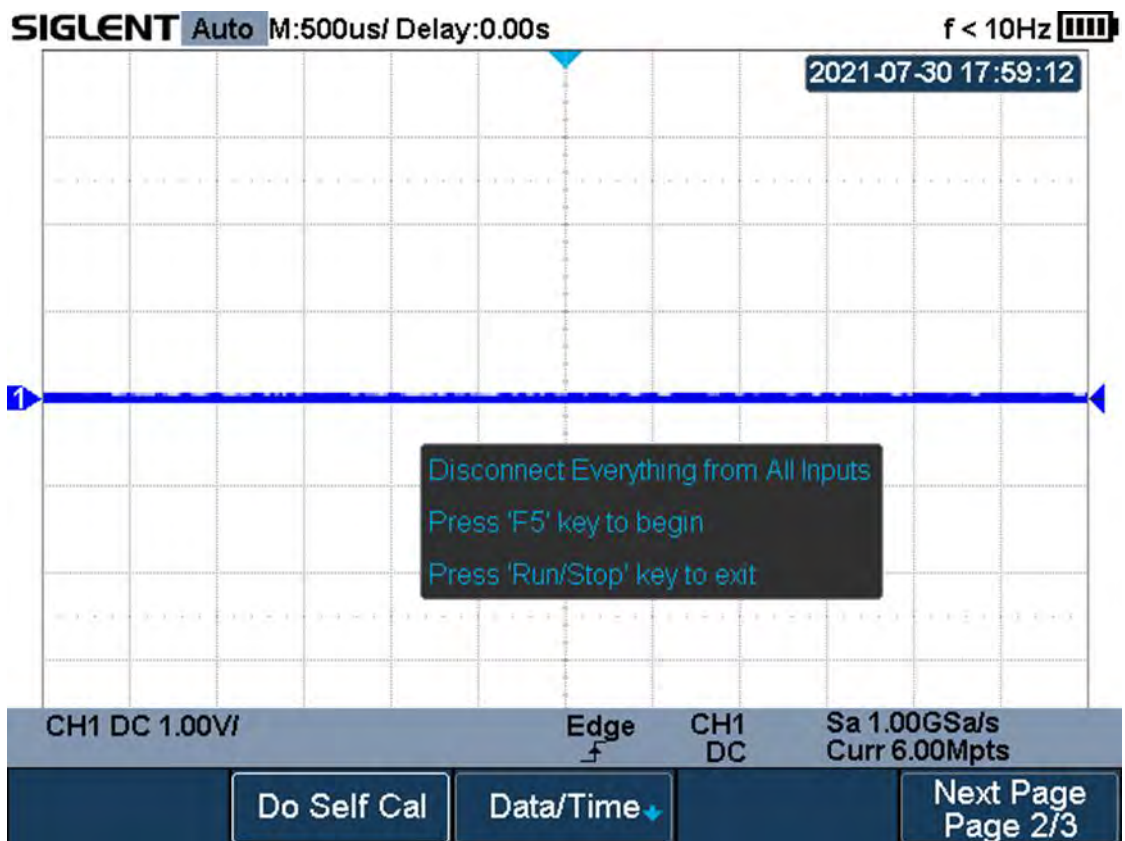
Рис. 20-2 Окно функции автоматической калибровки
