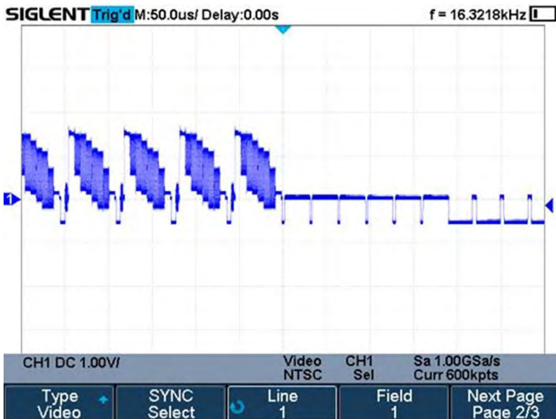
Рис. 11-6 Синхронизация по параметрам ТВ сигнала
