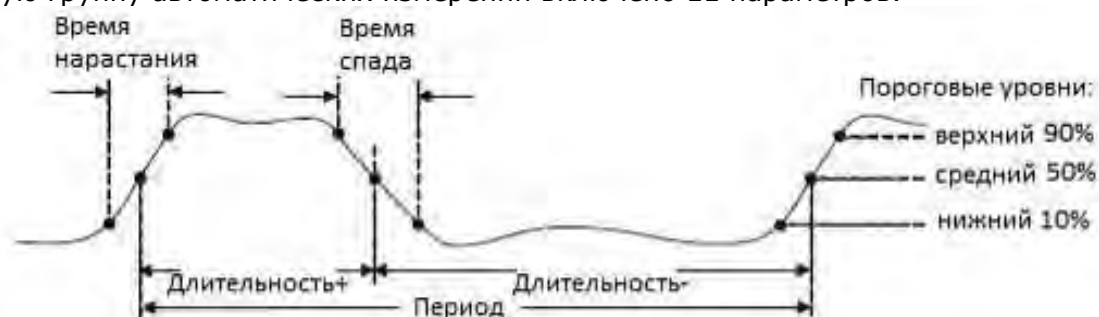
Рис. 16-4 Измерение временных параметров
