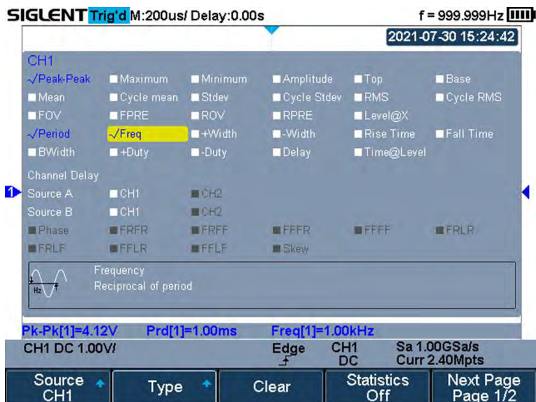
Рис. 16-5 Выбор типа автоматического измерения
