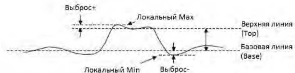
Рис. 16-2 Выбросы на импульсном сигнале
