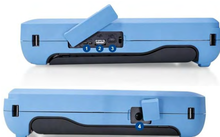
Рис. 6.2 Боковая панель осциллографа-мультиметра
