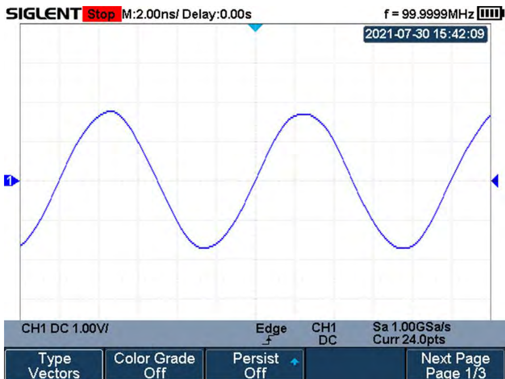
Рис. 17-1 Векторное отображение сигнала
