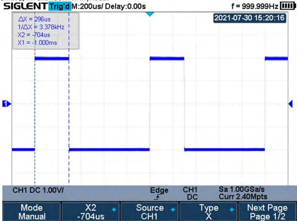
Рис. 15-1 Измерение длительности импульса
