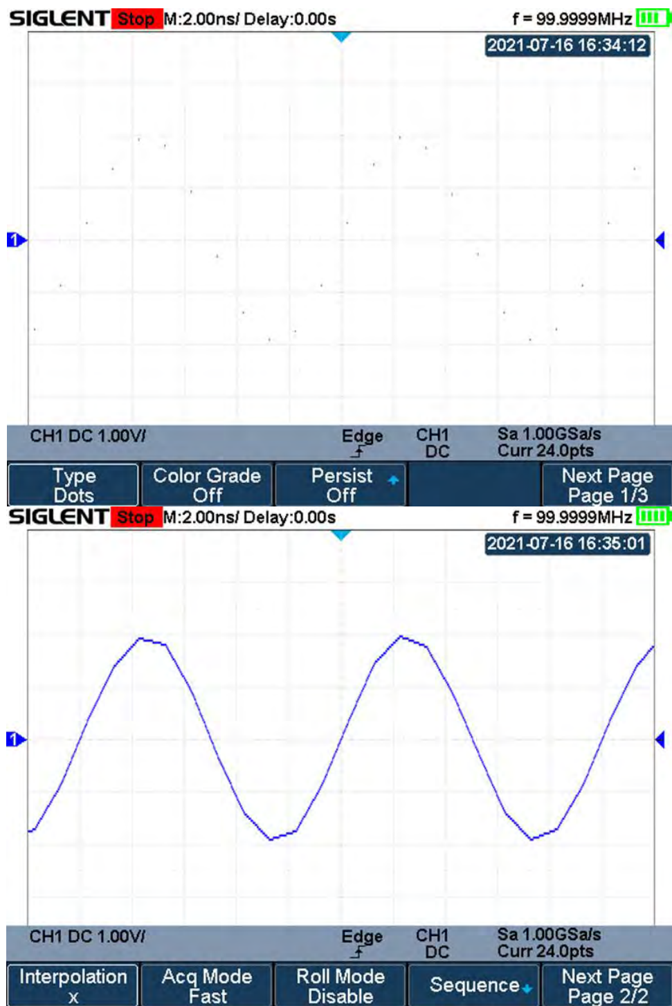
Рис. 10-2 Тип интерполяции – X
