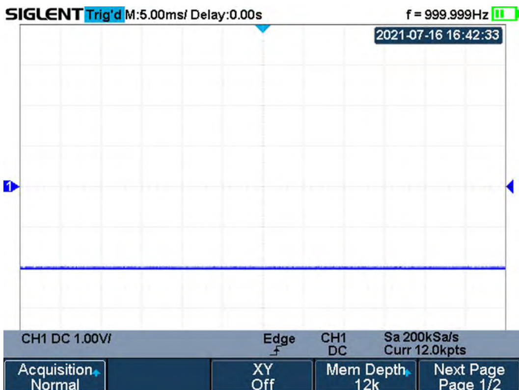
Рис. 10-6 Отображение импульсного сигнала с длительностью 0,1% Сквжности, в режиме стандартной выборки
