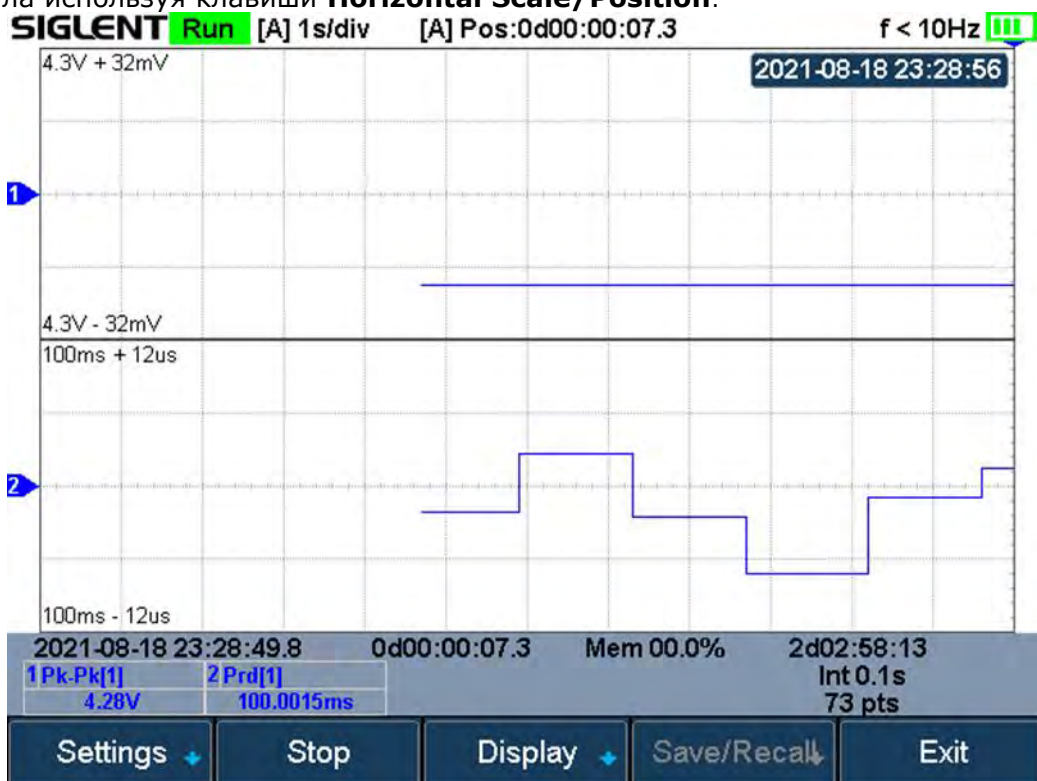
Рис. 24-6 Активная запись измеряемых данных
