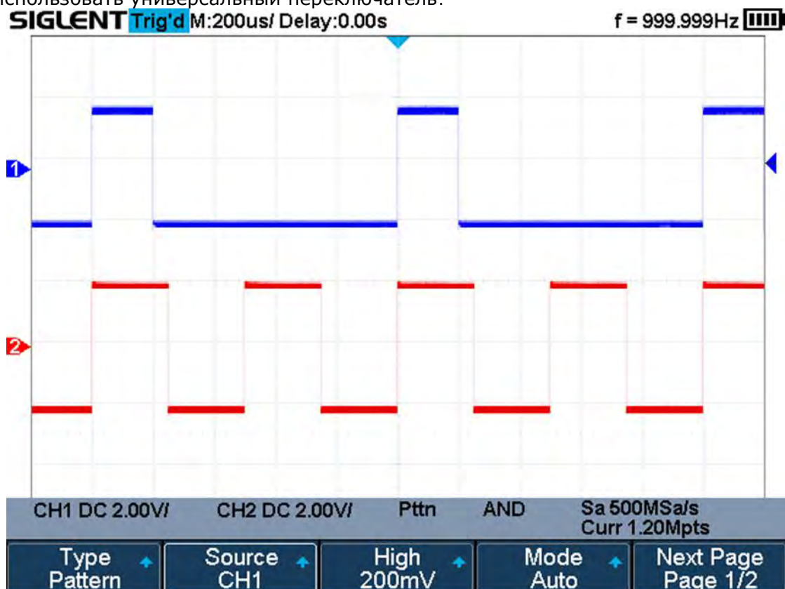
Рис. 11-13 Синхронизация по шаблону
