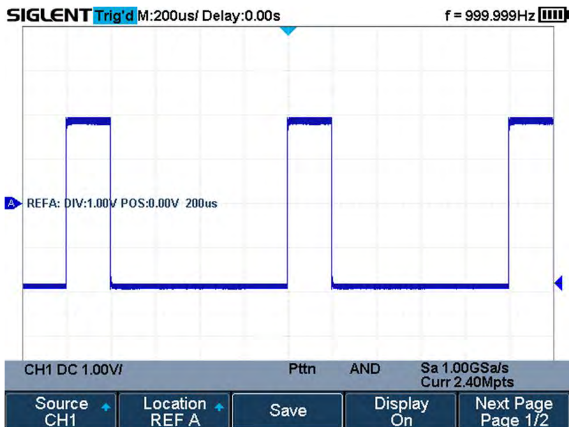
Рис. 13-1 Пример отображения опорной осциллограммы
