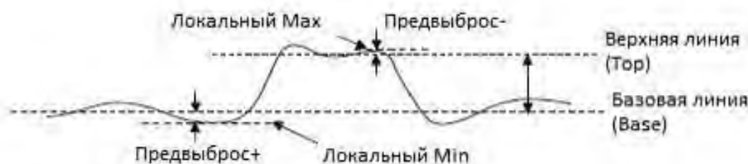
Рис. 16-3 Предвыбросы на импульсном сигнале
