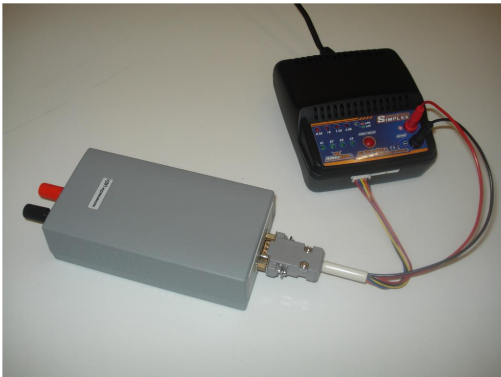
Рис. 4 – Подсоединение приемника для зарядки аккумуляторной батареи
