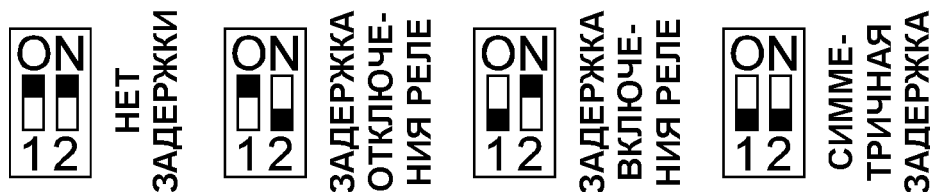
Рис. 6. Внутренние переключатели сигнализатора.
