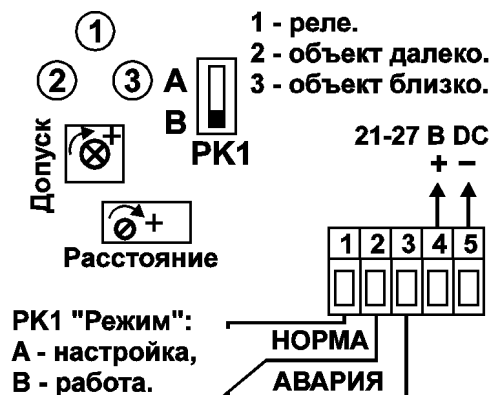
Рис. 7. Схема подключения, органы регулировки и индикации датчика.
