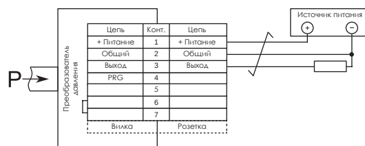
Схема подключения преобразователей с разъемом 2РМДТ 1857Ш1В1В, контакты 6 и 7 вилки соединены перемычкой
