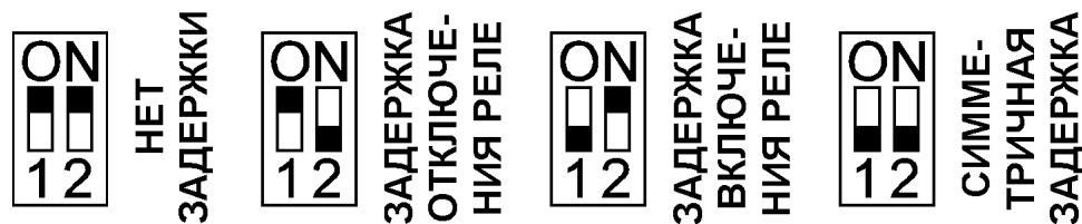
Рис. 3. Внутренние переключатели датчика.
