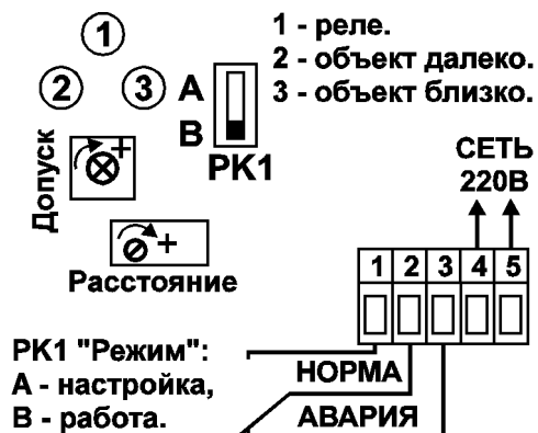
Рис. 7. Схема подключения, органы регулировки и индикации датчика.
